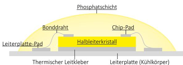
Diese LED Tracklights AR111 basieren auf der nachhaltigen COB-Technologie (Chip on board). Der Halbleiterkristall ist direkt mit der Leiterplatte (Substrat) verbunden. LEDs mit COB haben keine Leistungsverluste!
