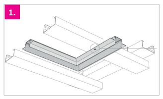
**Punto 1:** Il canale di installazione è avvitato alla sottostruttura del soffitto in corrispondenza delle ali laterali. Suggerimento: Svasare leggermente i fori preforati in modo che le viti siano a filo con il canale di installazione.
