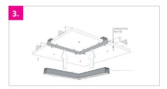
**Punto 3:** Sul retro del profilo LED Flexstrip inserire due clip di montaggio (numero articolo 112336) per un metro per il successivo fissaggio nel canale di installazione e quindi premere il profilo LED Flexstrip nel canale di installazione. Nota: Assicurarsi che tutte le clip di montaggio scattino in posizione (ascoltare il suono del clic).
