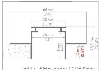
Possibilità di installazione a filo, senza cornice, per elementi in cartongesso e cartongesso con uno spessore massimo di 12,5 mm. Il profilo di installazione (numero articolo 112336) è fissato al canale di installazione (numero articolo 112334) con un meccanismo a clip.
