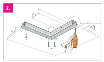
**Punto 2:** Preforare con un trapano le ali del canale di installazione e gli elementi in cartongesso o in cartongesso e poi avvitarli saldamente.
